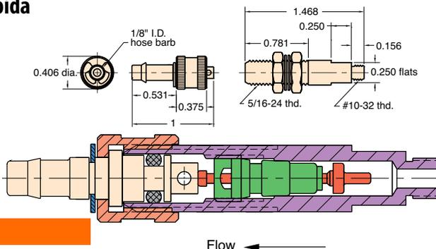
**Tipo:** Ensamble de cuerpo de válvula antirretorno de un sentido de conexión rápida MQC-V20 y conector de manguera MQC-F
