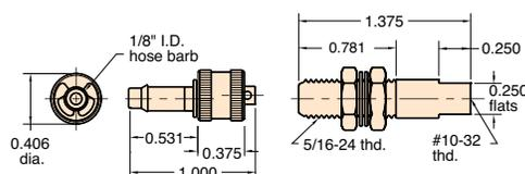
**Tipo:** Ensamble conexión rápida antirretorno en un sentido de cuerpo de válvula MQC-V20 y conector de manguera MQC-F
